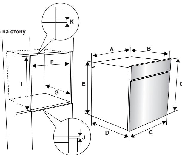
**1.** После подключения к электросети вставьте духовку в шкаф, продвигая ее от себя. Откройте дверь духовки и вставьте два винта в отверстия, расположенные на раме духовки. Убедившись, что рамка продукта соприкасается с деревянной поверхностью шкафа, затяните винты.
