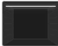
**Режим верхнего нагрева:** Включается термостат духового шкафа и сигнальные лампочки, верхний нагревательный элемент начинает работать. При таком
