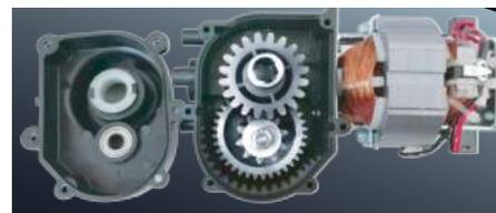
Усиленный приводной механизм двигателя
