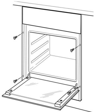
Используемый в производстве мебели клей должен выдерживать нагрев температуры до 90 градусов для избежания деформации внешнего покрытия.
