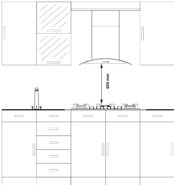
Дизайн изделия разработан в соответствии с доступными на рынке столешницами. Между стенами кухни и мебелью следует оставить безопасное расстояние. Если над варочной поверхностью будет устанавливаться вытяжка, соблюдайте требования производителя вытяжки относительно высоты монтажа (минимум 65 см). Вырез, в котором будет установлена варочная поверхность, на столешнице, должен соответствовать
