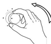
Удерживая ручку в нажатом состоянии и поворачивая влево, можно отрегулировать пламя
