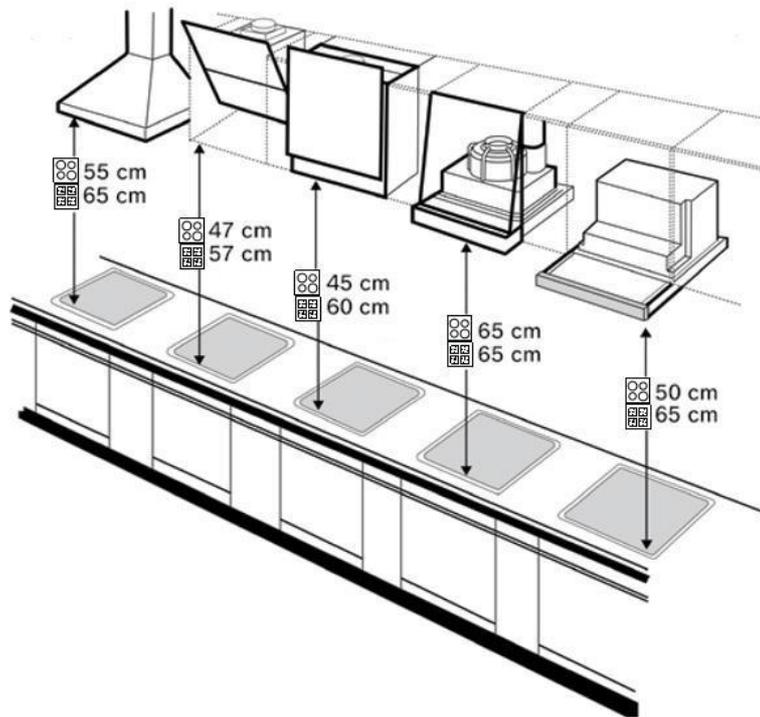
**Расположение:** Расстояние от нижней поверхности вытяжки до поверхности плиты должно составлять не менее 65 см.
