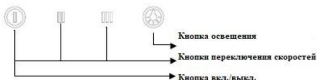
**Кнопка Вкл/Выкл:** Прикосновение к этой области начнет работать на 1-м уровне скорости при включении продукта. Нажмите на это поле, чтобы выключить продукт во время его работы.
