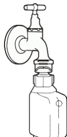
Подключение шланга с клапаном
