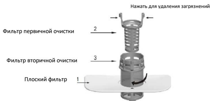
**▲ ПРИМЕЧАНИЕ:** Изображения предназначены для общего сведения. В разных моделях системы фильтрации и распылителей могут отличаться. Проверяйте фильтры после каждого использования устройства.
