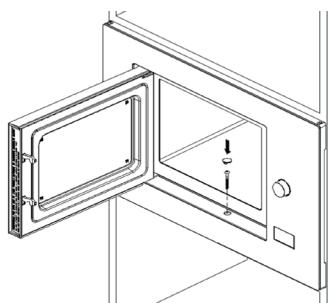
**5** Откройте дверцу, закрепите печь в нише с помощью винта в центре нижней части лицевой панели. Затем прикрепите пластиковую заглушку, чтобы закрыть монтажное отверстие.
