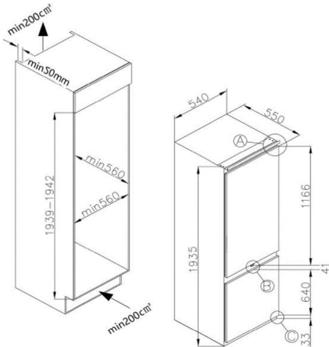
Данный холодильник предназначен для использования в качестве встроенного прибора.
