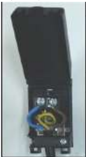
Рис. 2: Электрическое соединение кабеля прибора.
