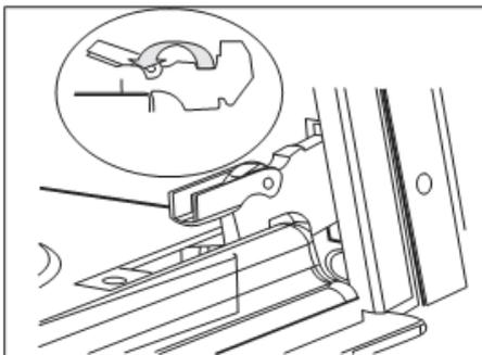
2. Приподнимите дверь, чтобы снять защелку, под углом приблизительно 15 градусов от передней рамы (см. рисунок В)
