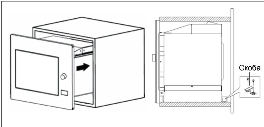
5. Откройте дверцу, зафиксируйте печь на полке с помощью винта В. Затем закройте отверстие шляпкой, которая входит в комплект.
