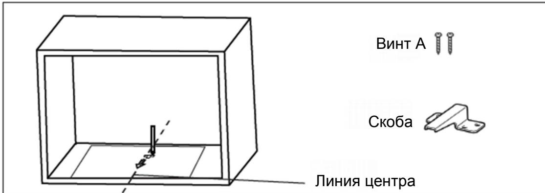
3. Уберите трафарет и зафиксируйте скобу с помощью винтов А.
