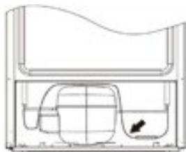
Задняя стенка холодильника, в частности конденсатор и другие элементы системы охлаждения, не должны соприкасаться с другими элементами, которые могут их повредить (например, трубы центрального отопления и водопровода).
